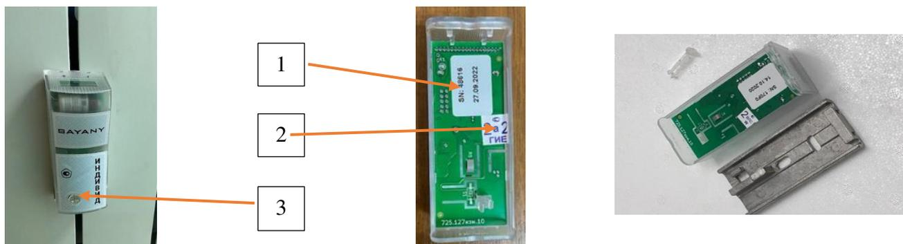
Рисунок 2 - пломбирование Распределителя
